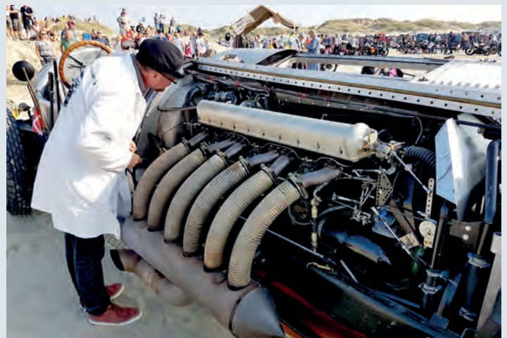
Norsk utsending frå Fram Motorcompagni studerer 27 liters Hispano-Suiza V12 motor lisensprodusert i Frankrike og montert i eit brannbil chassis.
